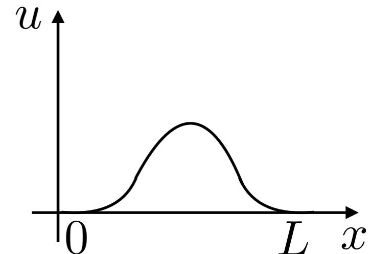
Condição de contorno  $u(0, t) = u(L, t) = 0 \quad \forall t \geq 0$
