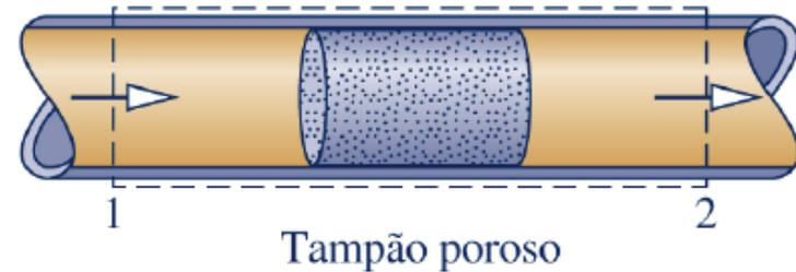
► **Dispositivos de estrangulamento**: é um dispositivo que consegue uma **redução significativa na pressão** através da introdução de uma restrição para uma linha através da qual um gás ou líquido flui. Meios para introduzir a restrição incluem uma válvula parcialmente aberta ou um tampão poroso.
