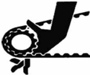
ção ou verificação, com o motor em funcionamento, deve-se desligar o mesmo antes de realizar estes procedimentos, evitando assim riscos de acidente através do contato com partes móveis, como as correias, polias ou cardãs.
