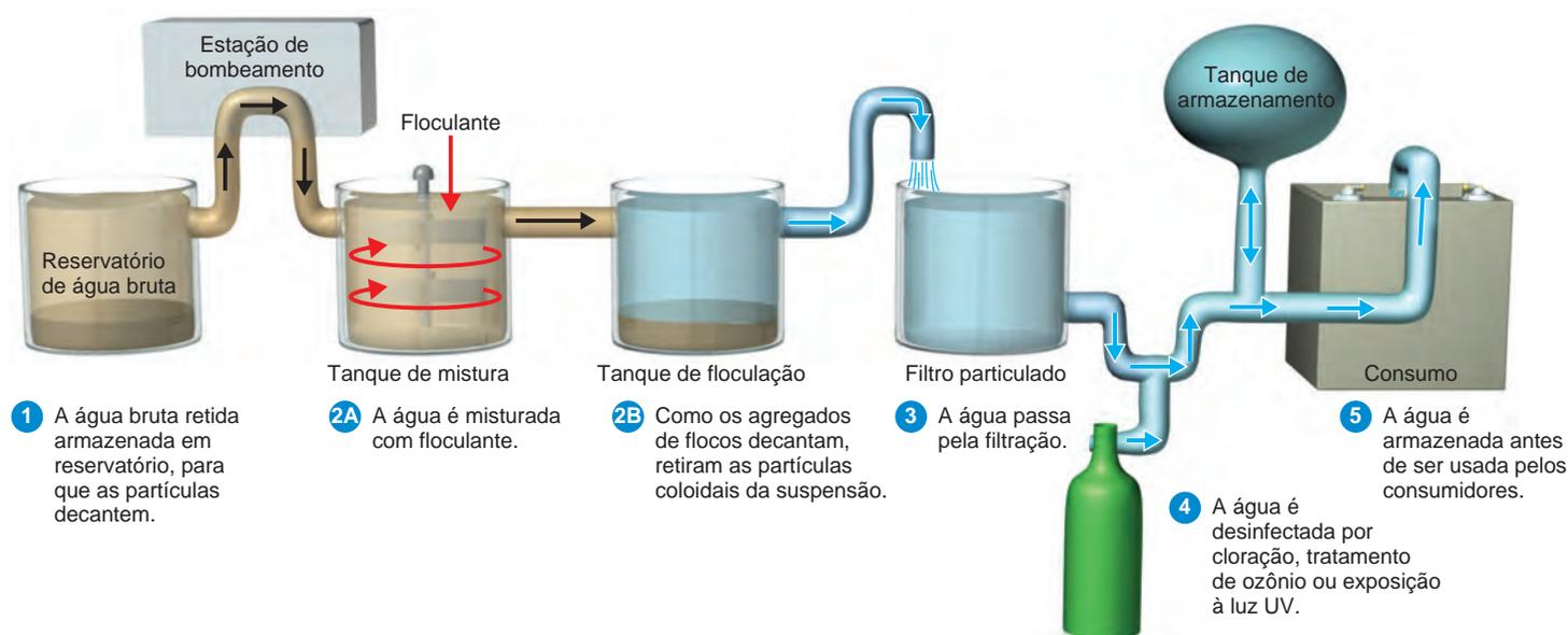
**Figura 27.15** As etapas envolvidas no tratamento de água em uma estação municipal típica de purificação de água.
