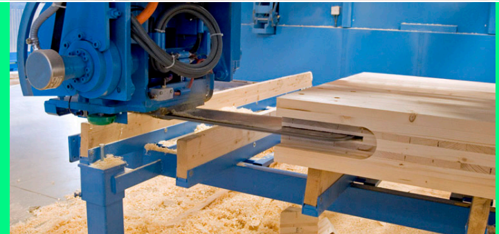
IMG. 9 Corte de peças no sistema Hundegger PBA. Imagem retirada de vídeo institucional Egoín: egoin.com/category/videos .
