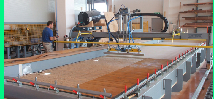
IMG. 7 Colagem de placas com adesivo de poliuretano. Imagem retirada de vídeo institucional Egoín: egoin.com/category/videos .
