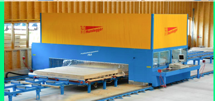
IMG. 10 Corte do painel CLT no sistema Hundegger PBA. Imagem retirada de vídeo institucional Egoín: egoin.com/category/videos .
