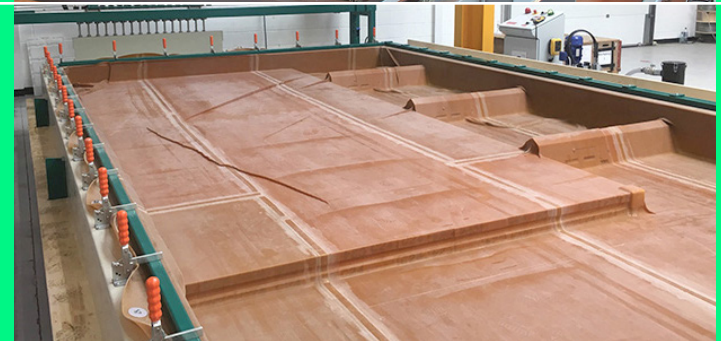
IMG. 8 Prensamento a vácuo do painel CLT. Imagem retirada de vídeo institucional Egoín: egoin.com/category/videos .
