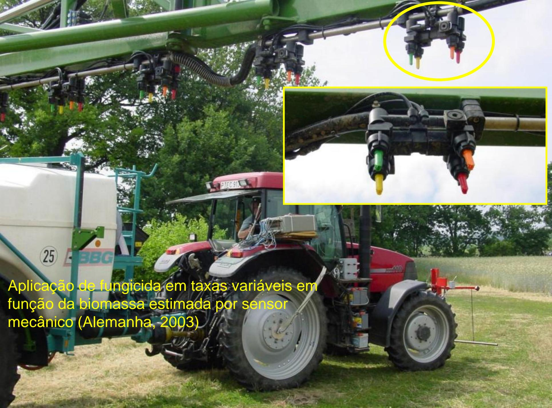
Aplicação de fungicida em taxas variáveis em função da biomassa estimada por sensor mecânico (Alemanha, 2003)
