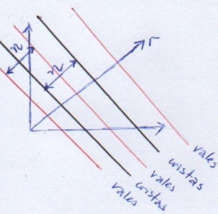
Essa geometria da solução das equações de onda é denominada onda linear (as frentes são retas). A distância entre duas frentes com a mesma fase (por exemplo, duas cristas de dois vales consecutivos) define o comprimento de onda  $\eta$ , tal que:
