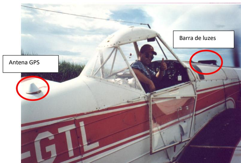
Figura x – Avião agrícola equipado com barra de luzes
