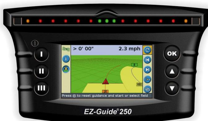
Figura x – Sistema de orientação com tela mostrando a estrada virtual e na parte superior a barra de luzes
