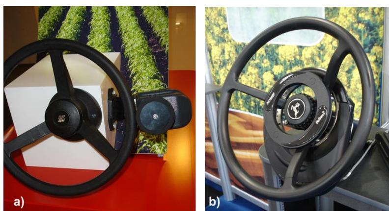
Figura x – Sistema de direção automática com atuador tipo motor elétrico com roda de atrito (a) ou centrado na coluna da direção do veículo (b).
