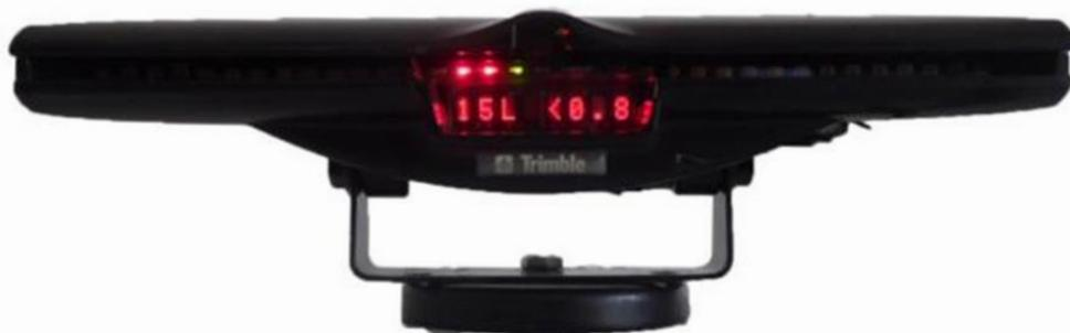
Figura x – O dispositivo denominado de barra de luzes com a fileira de LEDs, que acendem à medida que o veículo se afasta do alinhamento de referência.
