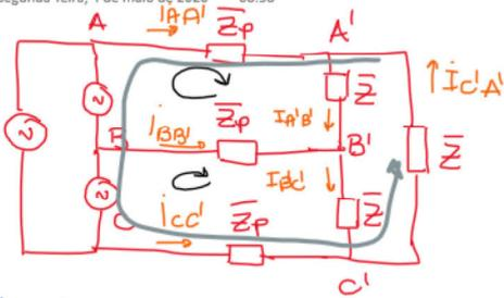
$$\begin{cases} -\dot{V}_{AB} + I_{AA'} \bar{Z}_p + I_{A'B'} \bar{Z} - I_{BB'} \bar{Z}_p = 0 \\ -\dot{V}_{BC} + I_{BB'} \bar{Z}_p + I_{B'C'} \bar{Z} - I_{CC'} \bar{Z}_p = 0 \\ -\dot{V}_{CA} + I_{CC'} \bar{Z}_p + I_{C'A'} \bar{Z} - I_{AA'} \bar{Z}_p = 0 \end{cases} +$$
