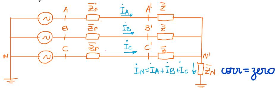
$$\begin{aligned} \dot{V}_{AN} &= \dot{I}_A \bar{Z}_P + \dot{I}_A \bar{Z} + (\dot{I}_A + \dot{I}_B + \dot{I}_C) \bar{Z}_N \\ \dot{V}_{BN} &= \dot{I}_B \bar{Z}_P + \dot{I}_B \bar{Z} + (\dot{I}_A + \dot{I}_B + \dot{I}_C) \bar{Z}_N \\ \dot{V}_{CN} &= \dot{I}_C \bar{Z}_P + \dot{I}_C \bar{Z} + (\dot{I}_A + \dot{I}_B + \dot{I}_C) \bar{Z}_N \end{aligned}$$
