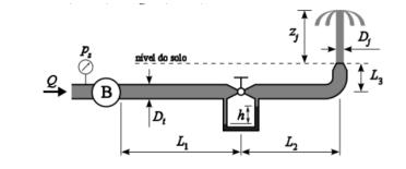
(a) O valor do coeficiente de perda localizada da válvula, *K*<sub>valv</sub>;
