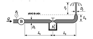
Aplicando-se a equação da conservação de energia entre a sucção da bomba (s) e a saída do bocal (j):
