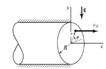
Utilizando a equação de Navier Stokes na direção z:
