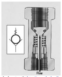
Figura 25 - Válvula de retenção http://www.hydraulicspneumatics.com/
