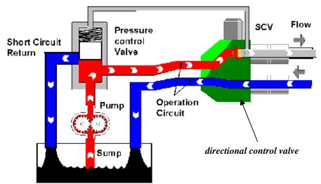
Figura 24 - Estando a válvula direccional (directional control valve) impossibilitada de passar óleo (flow), o aumento de pressão provocado pela bomba de óleo (pump) que continua a bombar, vai empurrar o êmbolo da válvula limitadora de pressão (pressure control valve), vencendo a força da mola (do outro lado do êmbolo), abrindo passagem para o reservatório do óleo (sump). Ficou, assim, aberto o retorno ao reservatório pela válvula de segurança (short circuit return).
