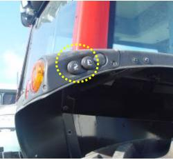
Figura 37 — Comandos no guarda-lamas para subida e descida dos braços inferiores em operação de montagem de alfaias
