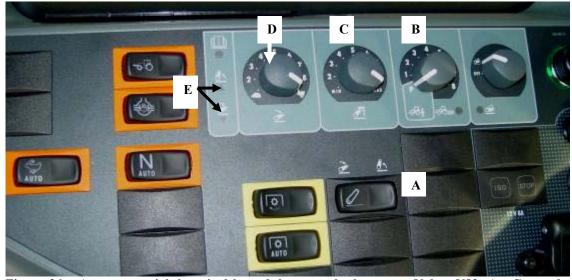
Figura 36 – Aspecto parcial do painel lateral de comando do tractor Valtra N82: A - Comandos para subida e descida dos braços inferiores em operação de montagem de alfaias; B - Comando de selecção (CS) de: controlo de posição, controlo de esforço de tracção, controlo misto; C - Comando de limite de altura máxima – CLAM; D - Controlo da velocidade de descida – CVD; E- Indicadores luminosos de subida/descida
