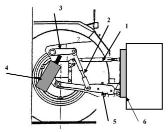
Figura 32 - Sistema de 3 pontos para ligação de alfaias (three point linkage / lifting system): 1 - Braço superior ou 3º ponto (top link); 2 - Pendural (lift rod); 3 - Braço de elevação (lifting arm); 4 - Cilindro hidráulico (hydraulic cilinder); 5 - Braço inferior (lower link); 6 - Cabeçote da alfaia (implement headstock).
