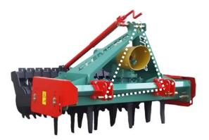
Figura 35 – Cabeçote da alfaia (*implement hedstocka*) - estrutura da alfaia através da qual esta se liga ao tractor.
