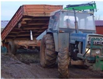
Figura 16 - O semi-reboque (farm trailer) da figura dispõe de um CHSE para rebater (tip) a caixa; O peso da caixa fará recolher a haste do cilindro. Aula do Mestrado de Olivicultura e Azeite -Herdade de Torre de Figueiras (Monforte)
