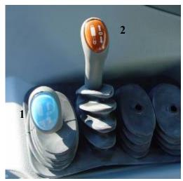
Figura 50 – Comando das válvulas do SESH do tractor Vatra N82. A válvula 2 possui detenção na posição de recolher, com flutuação.
