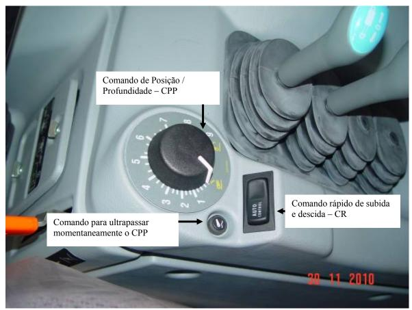
Figura 39 – Painel à direita do volante do tractor Valtra N82 usado nas aulas de 2010/11
