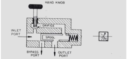
Figura 28 - Válvula reguladora de caudal - válvula divisora de fluxo (flow-divider valve)
