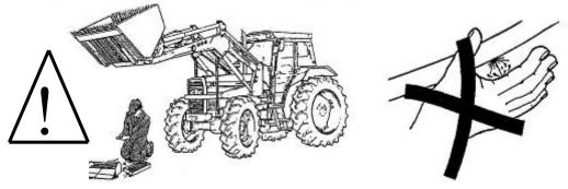
O óleo do sistema hidráulico, sob pressão, pode penetrar na pele ou nos olhos, causando sérios danos físicos e cegueira. A fuga de um fluído sob pressão pode não ser visível, pelo que em caso de inspecção, utilize um pedaço de cartão ou de madeira e
