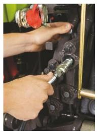
Figura 43 – Ligação do acoplamento macho à tomada do SESH do tractor (acoplamento fêmea)
