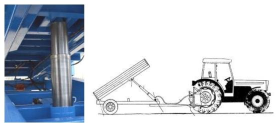
Figura 17 - Cilindros telescópico para possibilitar que, quando recolhida, a haste ocupe o menor espaço possível.
