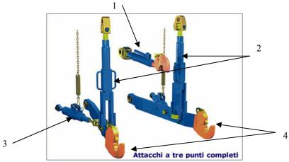
Figura 31 - Sistema de 3 pontos para ligação de alfaias (three point linkage / lifting system): 1 - Braço superior ou 3º ponto (top link); 2 - Pendural (lift rod); 3 - Esticador (stabiliser); 4 - Braço inferior (lower link).
