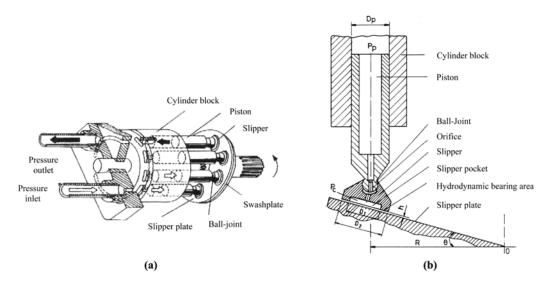
Figura 8 - Bomba de êmbolos axiais de débito variável (Swashplate pump)
