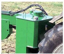
Figura 2 - Reservatório de óleo do sistema hidráulico autónomo de uma máquina de revestir fardos de feno-silagem em película plástica <a href="http://www.mchale.net/">http://www.mchale.net/</a>
