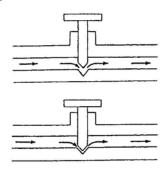
Figura 27 - Princípio básico de uma válvula de regulação de caudal
