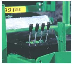
Figura 57 - Conjunto de válvulas que distribuem óleo para os diversos actuadores www.mchale.net
