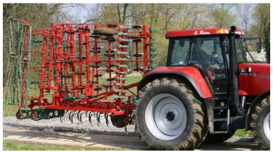
Figura 13 - Os dois cilindros hidráulicos assinalados, <u>actuados em paralelo</u>, rebatem o corpo do lado esquerdo do vibrocultor. Um segundo par de CHDE <u>actuados em paralelo</u> rebate o corpo direito <a href="http://kvernelandgroup.papirfly.no">http://kvernelandgroup.papirfly.no</a>
