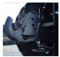
Figura 34 - Na extremidade dos braços inferiores existem engates rápidos (quick couplers) para ligar ao cabeçote da alfaia.
