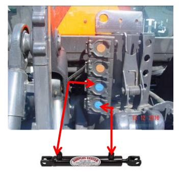
Figura 47 – Ligação de um cilindro hidráulico de duplo efeito às tomadas da válvula 1
