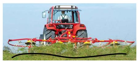
Figura 49 - Os cilindros hidráulicos deverão estar ligados a válvula do SESH com flutuação
