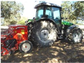
Figura 40 – Sementeira com um semeador mecânico de linhas; situação de utilização do controlo flutuante da alfaia (CFA). Herdade das Lages Grandes, unidade Curricular Tractores e Equipamentos Automotrizes
