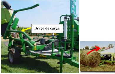
Figura 53 - Braço de carga do fardo para a mesa rotativa www.mchale.net
