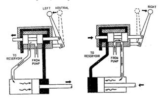
Figura 26 - Movendo para a esquerda a alavanca de comando da válvula direccional, fica permitida a passagem de óleo vindo da bomba para o lado esquerdo do cilindro; simultaneamente, o lado direito do cilindro fica ligado ao reservatório. Assim, com a entrada de óleo no lado esquerdo e saída no lado direito, a haste do cilindro estende. Movimentando a alavanca de comando da válvula direccional para a direita realiza-se o oposto
