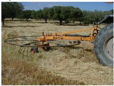
Figura 46 – Virador juntador de feno cujo posicionamento lateral em relação ao tractor é efectuado por um cilindro hidráulico de dulo efeito ligado ao SESH do tractor
