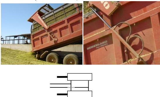
Figura 11 - Taipal traseiro (rear door) de semi-reboques, actuado hidraulicamente, é operado por dois CHDE (um de cada lado do taipal) em paralelo. Tractores e Equipamentos Automotrizes 2011/12 – Visita à herdade dos Padres
