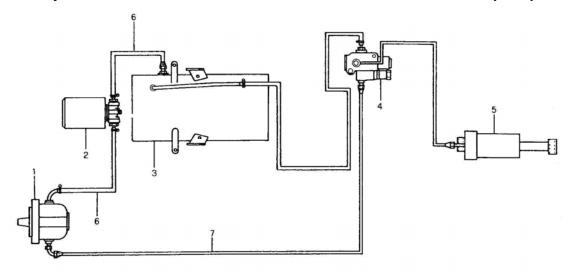
Figura 1 – Esquema simplificado de uma transmissão hidráulica
