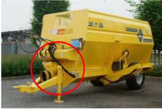
Figura 60 – Semi-reboque misturador e distribuidor de ração (mix feeders) são exemplos frequentes de equipamentos com sistema hidráulico autónomo www.sgariboldi.it
