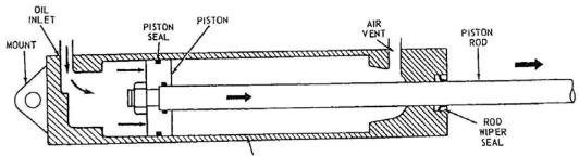
Figura 15 - Cilindro hidráulico de simples efeito. Notar a ligação à atmosfera no lado direito do cilindro (orifício ventilador)
