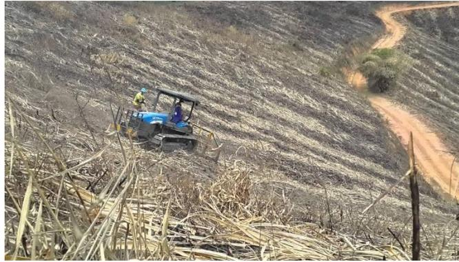
Figura 9 - Trator trafegando em terreno inclinado: risco de tombamento.
