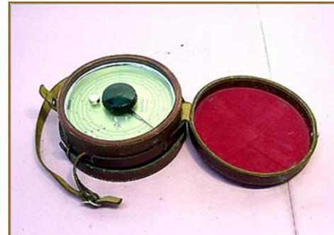
Figura 24 - Barômetro metálico.
