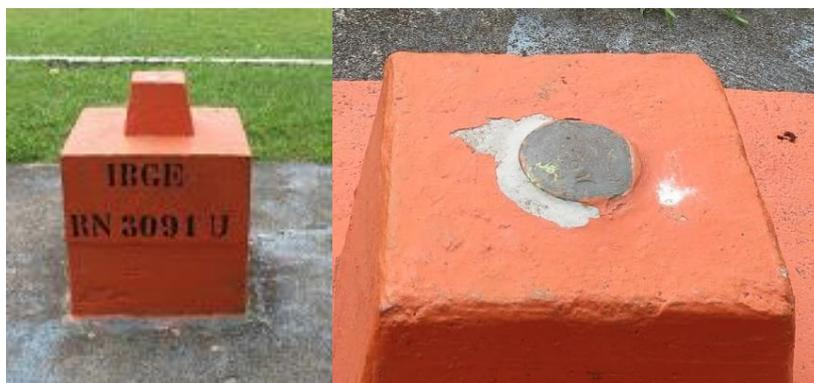
Figura 12- Marco geodésico implantado em Imbituba, SC.
