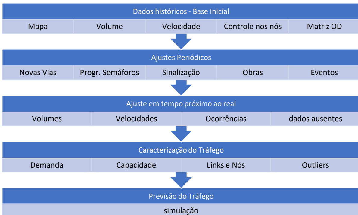
Figura 3.1 – Passos de Preparo e Caracterização do Tráfego para uso no sistema de Previsão com Simulador de Tráfego
