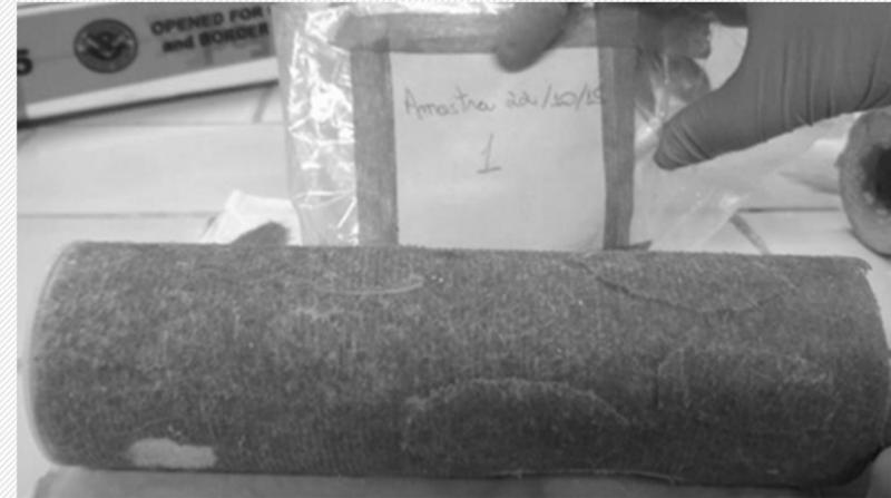
Amostra de filtro cartucho com deposição de ferro devido à corrosão de equipamentos à montante da sua instalação
