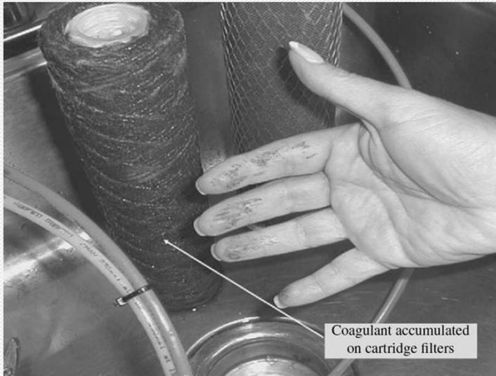
Filtro cartucho com depósito de ferro em função da dosagem excessiva no sistema de pré-tratamento
