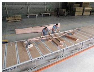
Processo de fabricação das tesouras.
