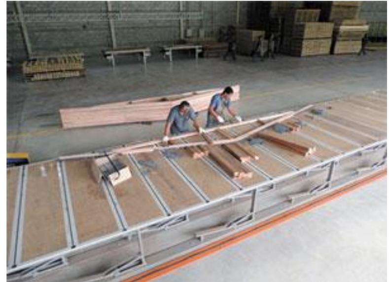
Processo de fabricação das tesouras.
