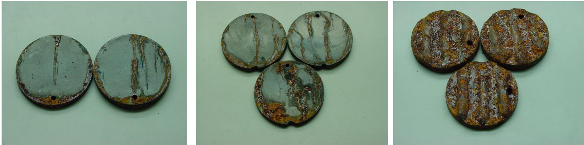
Figura 4.26 - Amostras com tratamento de nitretação em banho de sais. a) solubilizada, b) solubilizada-sensitizada, c) solubilizada-soldada (Referência: Silvio Tado Zanetic, Relatório Final do Auxílio à Pesquisa Fapesp, processo: 00/12162-5 )
