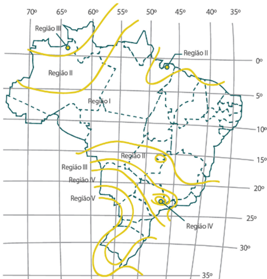
Figura 24 – Regiões brasileiras para efeito de estanqueidade à água (Fonte NBR 15575-4).
