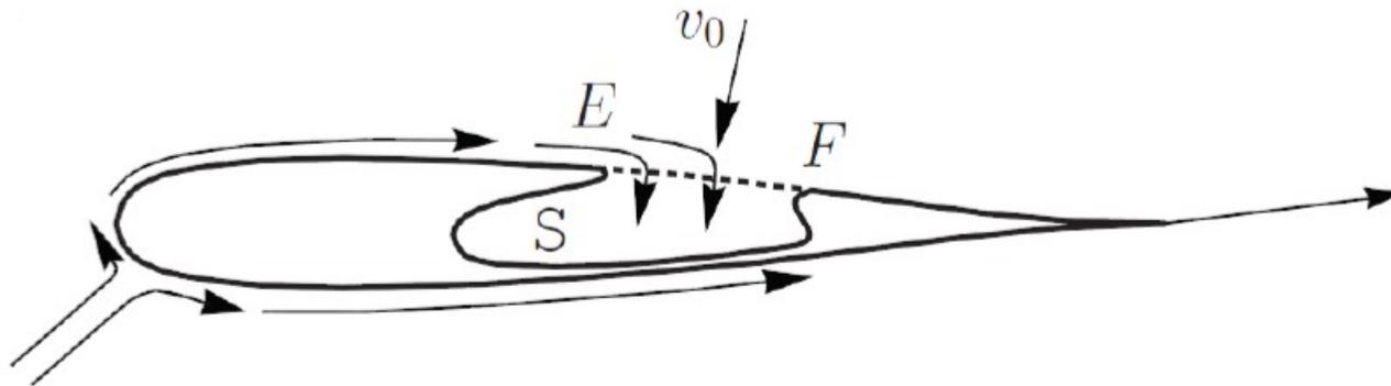
Exemplo de controle ativo da camada limite por sucção. Extraído de
