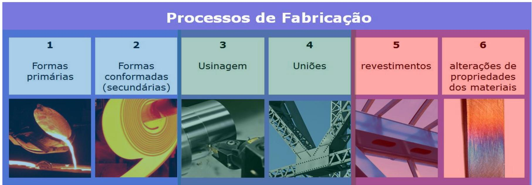
**Processos primários** - alteram as matérias primas, transformando-as em geometrias e formas básicas. Ex. fundição, laminação, forjamento
