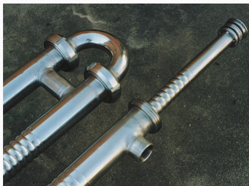
Tubos múltiplos em um trocador de calor (fonte: Tetra Pak)
