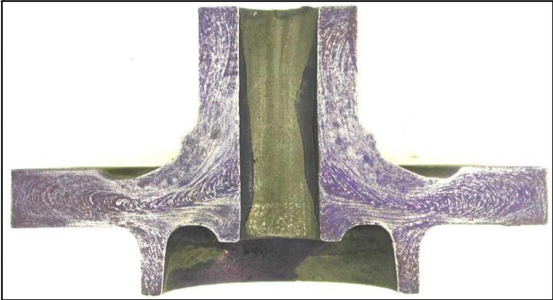
**FIBRAMENTO/FIBRAGEM: PARTÍCULAS (INCLUSÕES, GRAÇOS PERLÍTICOS) ALINHADOS COM O FLUXO DE MATERIAL.**
