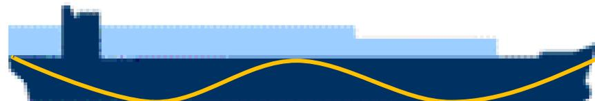
Quando a velocidade é tal que a onda gerada tem o mesmo comprimento do navio, qualquer aceleração fará com que o navio comece a “subir” a onda, aumentando enormemente a resistência
