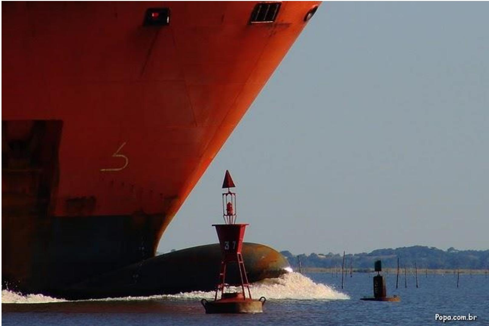
Além da onda gerada pelo casco, existe a formação de uma onda gerada pelo próprio bulbo: essa onda é formada mais à vante e em defasagem com relação à onda formada pelo casco.
