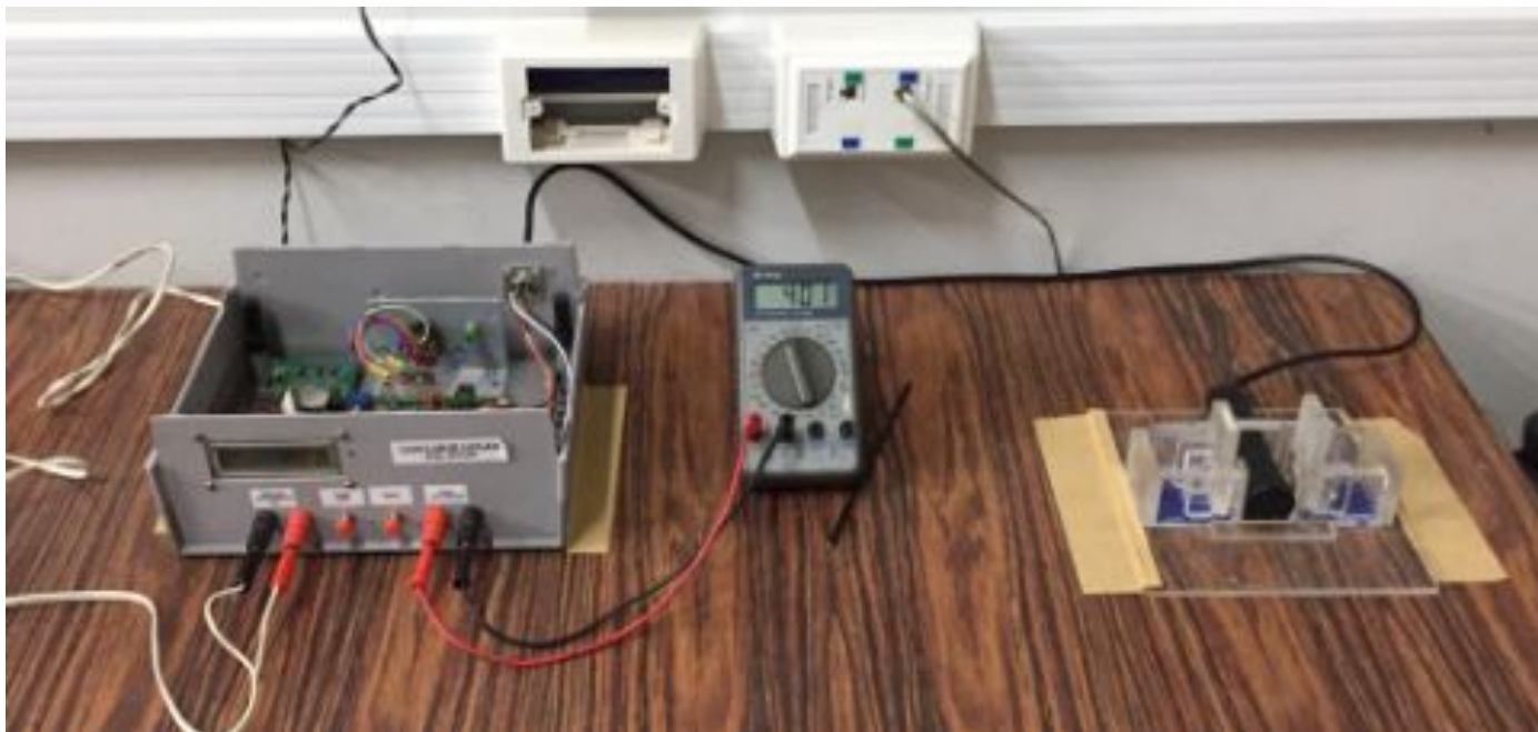
Figura 9: Geiger Muller com circuito aberto utilizado no experimento
