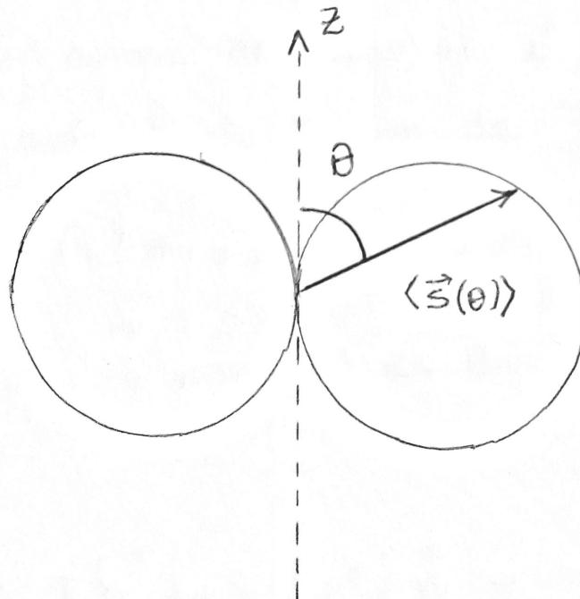
Ou seja, nenhuma radiação é emitida ao longo do eixo do dipolo. A intensidade é máxima para direções perpendiculares ao eixo do dipolo.
