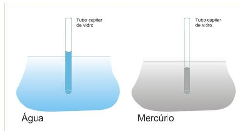
Figura 2: Esquemas do fenômeno da capilaridade entre água-vidro-ar e Hg-vidro-ar.
