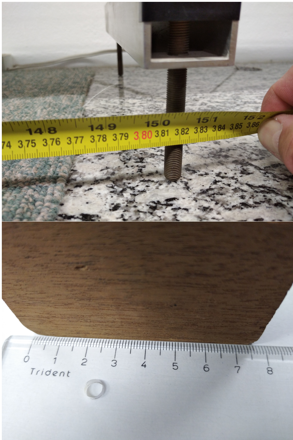
Figura 2: Medidas do comprimento da base do trilho de ar e da altura do calço que inclina o trilho.
