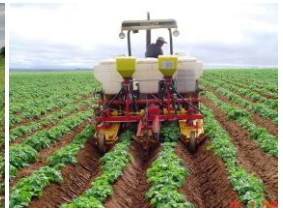
Amontoa realizada com equipamento de tração mecanizada.
