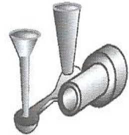
Peça acabada, mostrando o canal de entrada do massalote e o condutor conectados
