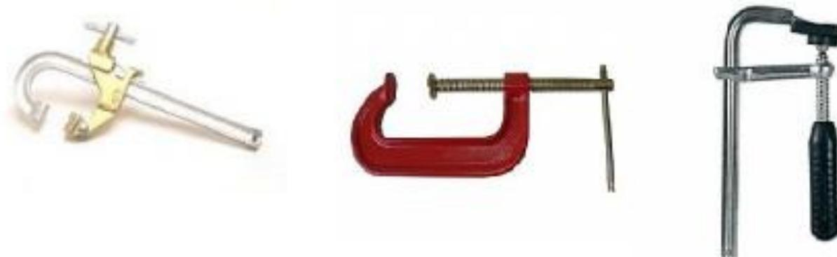
**Figura 8.** Grampos ou sargentos de fixação tipo C
