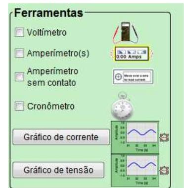
Para se utilizar os gráficos de corrente e de tensão, basta clicar no nome. Podemos utilizar quantos desses elementos precisarmos no circuito. Neles temos o eixo horizontal do tempo (que não se tem como mudar a escala) e o eixo vertical de Tensão ou de Corrente. Sobre esse eixo tem o sinal de menos e de mais. Menos (menor precisão) nos dará uma escala com valores maiores e Mais (maior precisão) nos dará uma escala com valores menores seja da corrente, seja da tensão.
