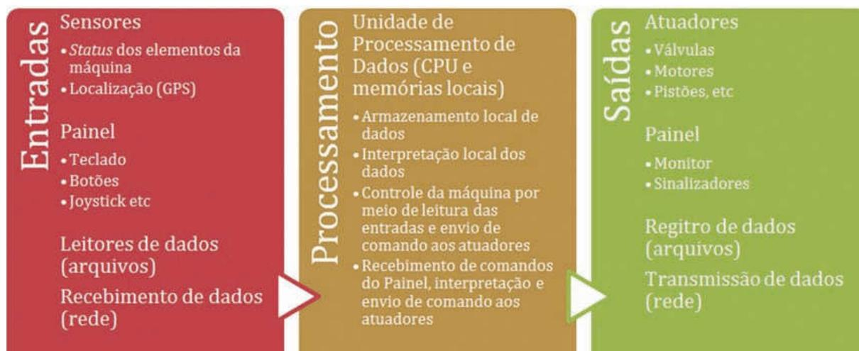
**Figura 4.** Sistema de controle baseado em microprocessadores.
