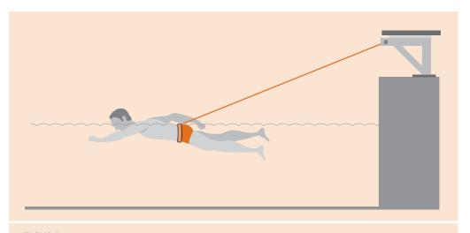
**FIGURA 5.13** Aparelho de treinamento da força de tração para nadadores.
