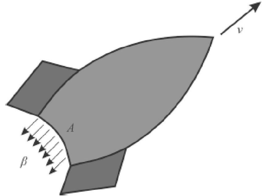
$$\dot{m}_{foguete} = \rho V_{gases,foguete} A \Rightarrow \beta = \rho V_{gases,foguete} A \Rightarrow V_{gases,foguete} = \frac{\beta}{\rho A}$$
