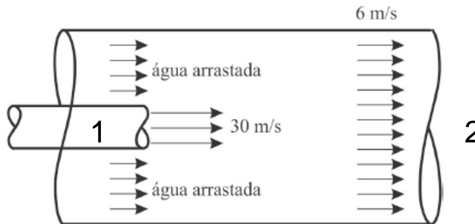
$$A_1 = 0,01 \text{ m}^2 \quad V_1 = 30 \text{ m/s} \quad A_2 = 0,075 \text{ m}^2 \quad V_2 = 6 \text{ m/s}$$
