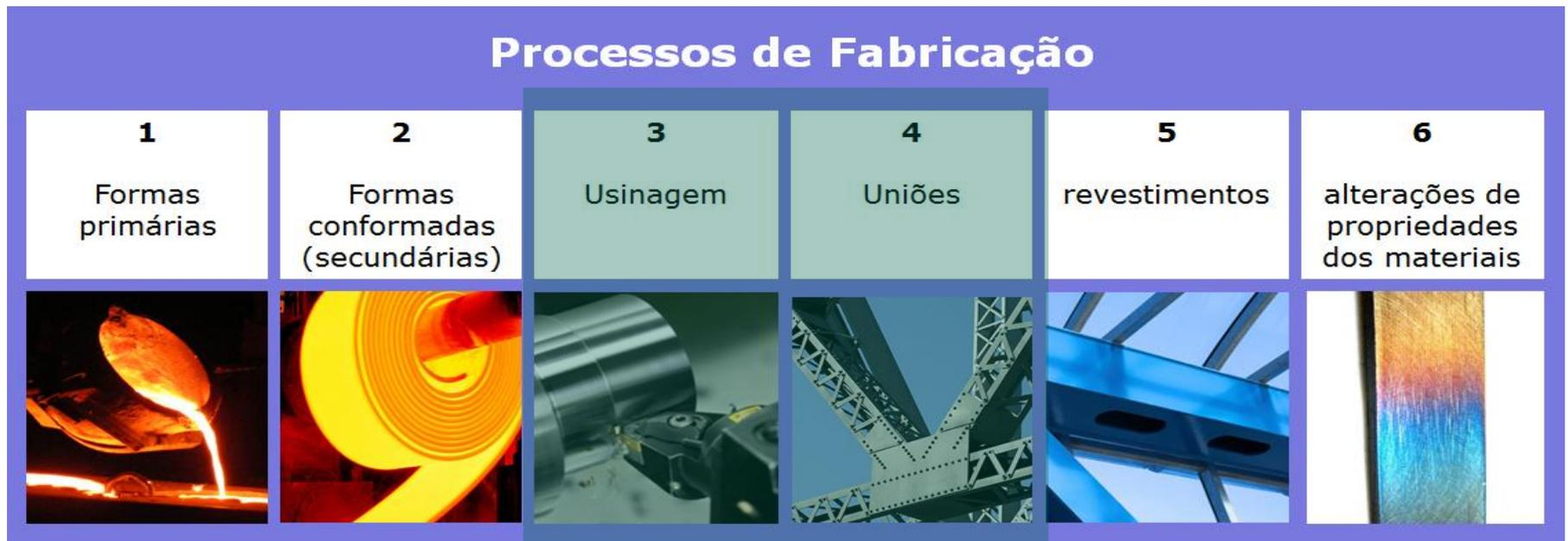
**Definição da usinagem** - segundo a norma DIN 8580, o termo usinagem aplica-se a todos os processos de fabricação onde ocorre a remoção de material sob a forma de cavaco.
