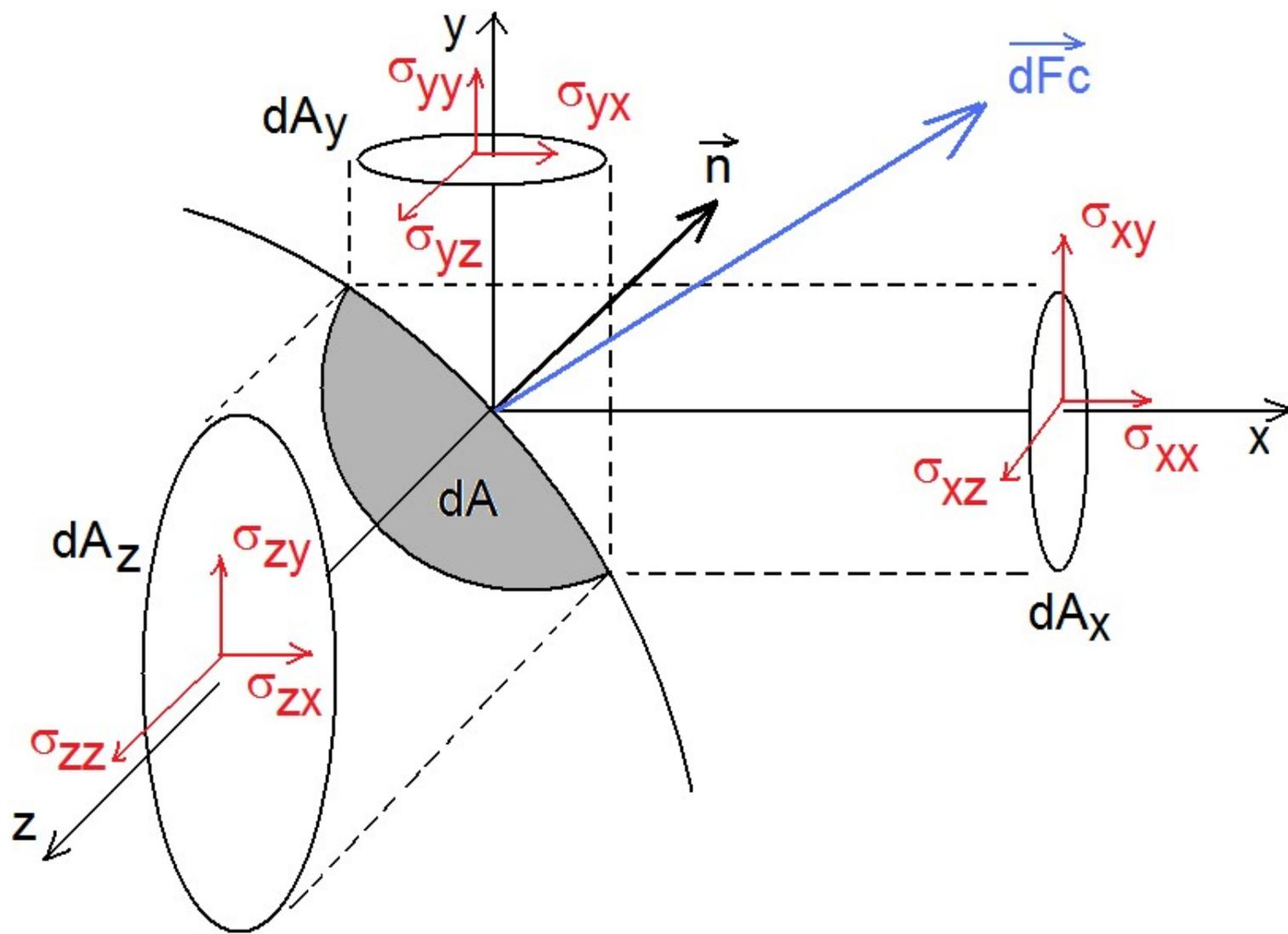
A força de contato  $dFc_i$  pode ser relacionada com o tensor das tensões calculado no centróide do elemento de área  $dA$ . Esse elemento de área tem projeções  $dA_x$ ,  $dA_y$  e  $dA_z$  nos planos ortogonais aos eixos  $x$ ,  $y$  e  $z$ . o tensor das tensões é um tensor do tipo:
