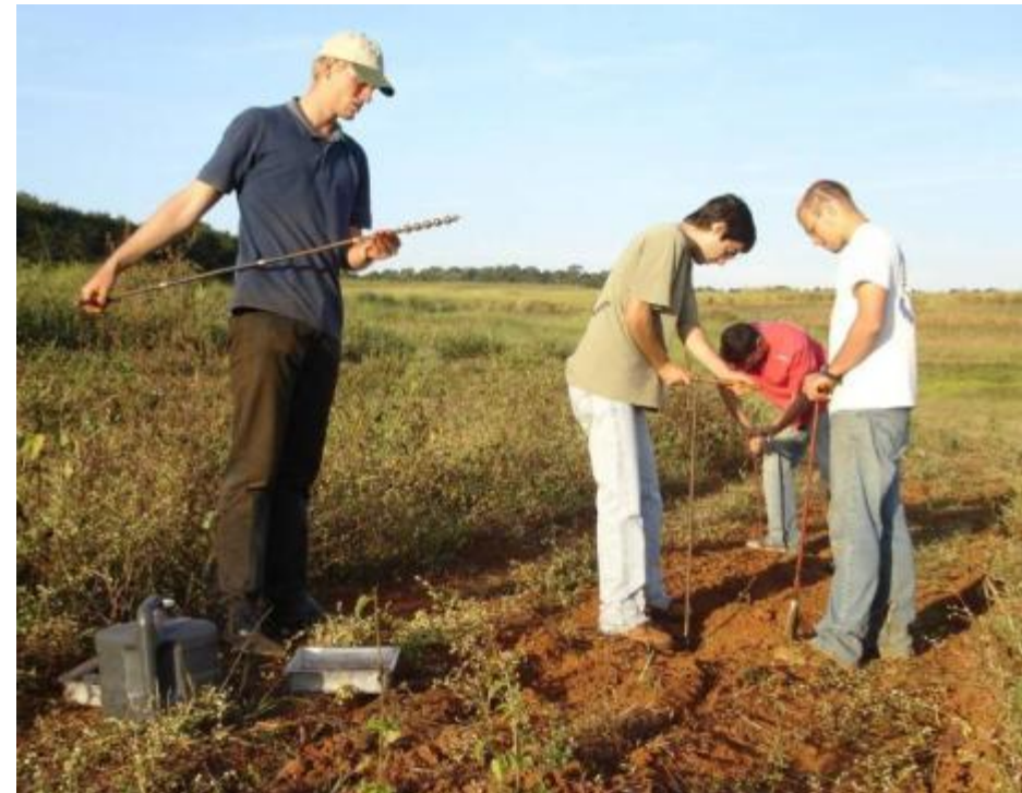
Amostragem de solo com trado de rosca, operado manualmente
