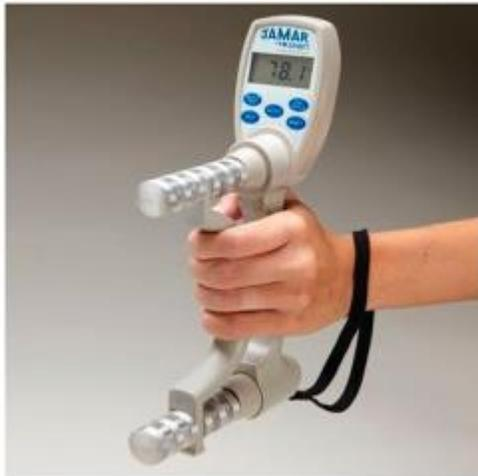
O dinamômetro de mão de Jamar é um tipo de dinamômetro isométrico e é usado para medir a força de preensão manual
