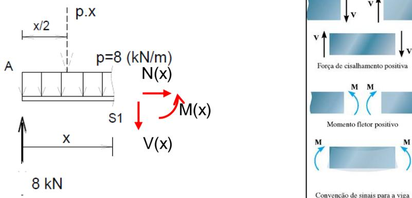
Ao aplicar o corte, a estrutura fica dividida sempre em duas partes.
