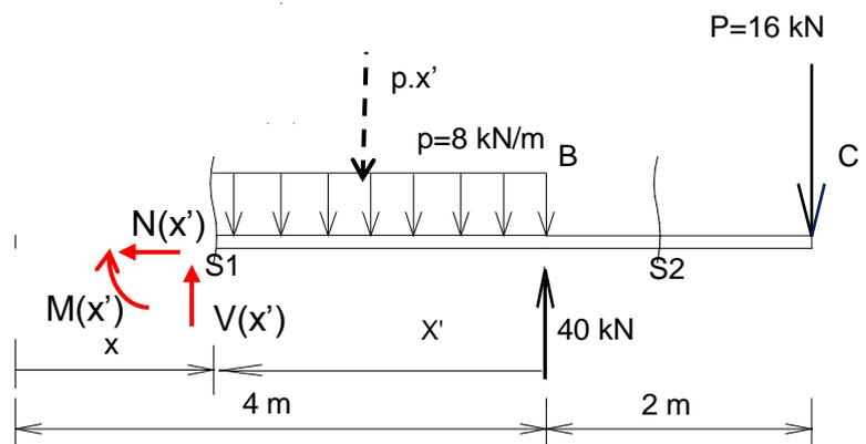
Lembrando da convenção de sinais para os esforços solicitantes no caso da viga horizontal (**força normal positiva é a de tração, força cortante positiva faz o corpo rígido girar no sentido horário, momento positivo traciona a fibra inferior do corpo rígido**), lançam-se esses esforços de acordo com a figura.
