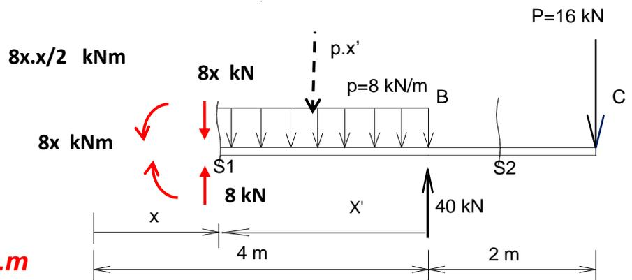
**3ª possibilidade:** Considerando a parte da direita, na seção transversal S1, há uma força normal  $N(x')$ , ortogonal à S1, uma força cortante  $V(x')$  no plano de S1 e um momento fletor  $M(x')$ , tracionando a fibra inferior da seção transversal S1, com o  $x'$  variando de zero (em B) até 4 metros (em A).
