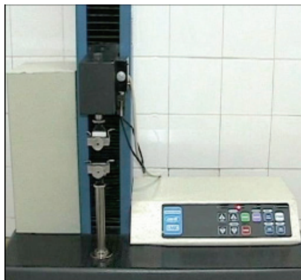
Máquina universal de ensaio mecânico computadorizada, da marca EMIC®, modelo DL-500-MF, com garras de pressão ajustáveis.
