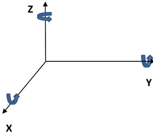
Figura 1. Representação das rotações em torno de eixos fixos.
