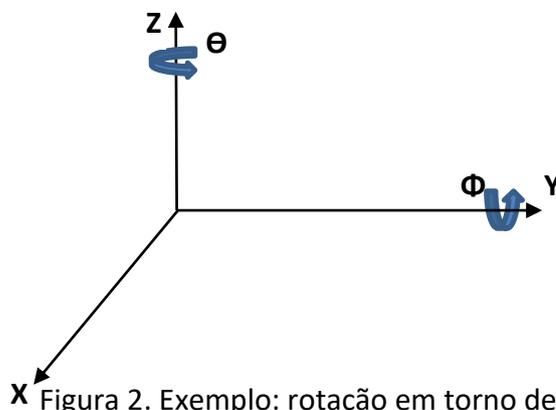
Figura 2. Exemplo: rotação em torno de Y seguida de uma rotação em torno de Z
