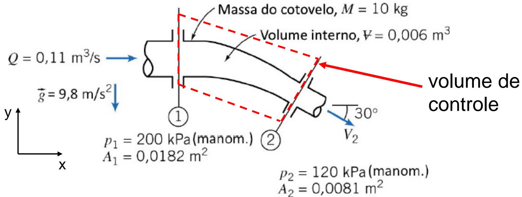
Para a direção x: o volume de controle não se movimentando ( $\vec{a}_{VC} = 0$ ) e não variação do volume de controle ( $dV = 0$ )
