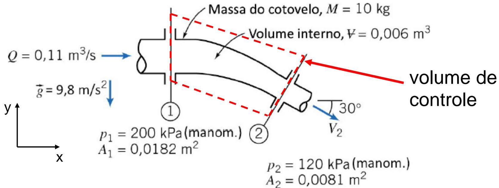
Para a direção  $x$ : o volume de controle não se movimentava ( $\vec{a}_{VC} = 0$ ) e não variação do volume de controle ( $dV = 0$ )
