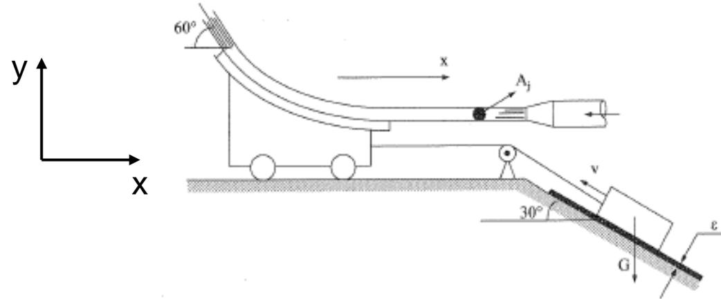
$$-v_{jato} \rho_{\text{água}} (v_{jato} - v) - \rho_{\text{água}} v_{jato} A_{jato} (v_{jato} \cos 60^\circ - v) + \\ -\rho_{\text{água}} v_{jato} A_{jato} [-(v_{jato} - v)] = F_{\text{viscosa}} + G \cos 60^\circ$$
