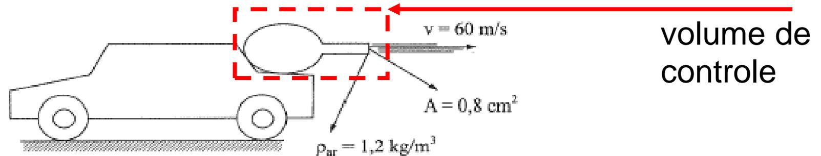
Assumindo o volume de controle mostrado na figura acima (bexiga), aplica-se a equação da quantidade de movimento, sendo:  $dV = 0$   $\vec{a}_{VC} = 0$
