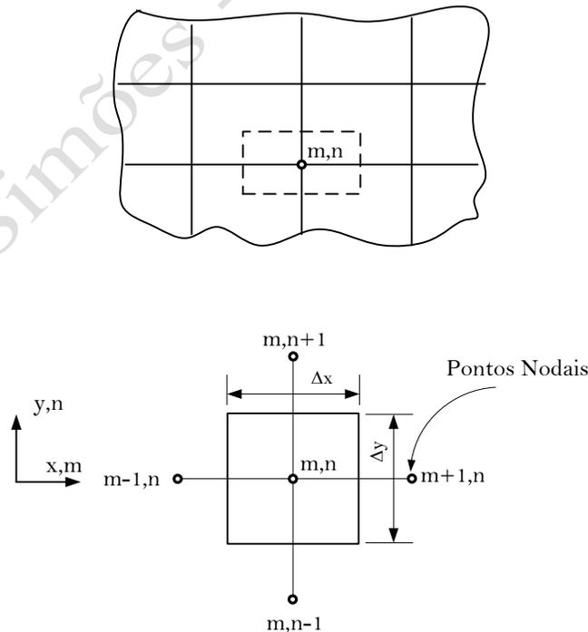
A equação da condução de calor em RP, 2-D é dada por  $\frac{\partial^2 T}{\partial x^2} + \frac{\partial^2 T}{\partial y^2} = 0$ . Ela pode assim ser assim discretizada:
