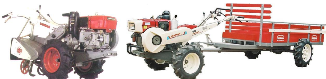
Figura 15. Microtrator de rabiças na versão equipado com enxada rotativa para preparo do solo e com carreta para transporte (Google Imagens)
