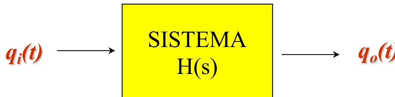
Definição: Função transferência é o quociente entre as *transformadas de Laplace* da saída  $q_o(t)$  pela entrada  $q_i(t)$ , sendo *nulas* todas as demais entradas e condições iniciais do sistema. Algebraicamente
