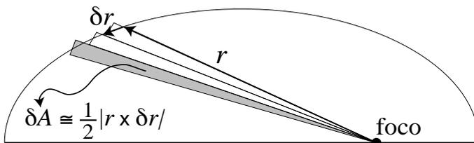
Figura 5.7: Área varrida pelo raio vetor  $r$  que percorre uma elipse.
