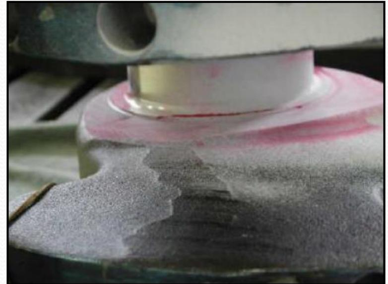
**ENSAIO NÃO DESTRUTIVO DE LÍQUIDO PENETRANTE APÓS ENSAIO DE FADIGA PARA DETERMINAR LOCAL DA TRINCA.**
