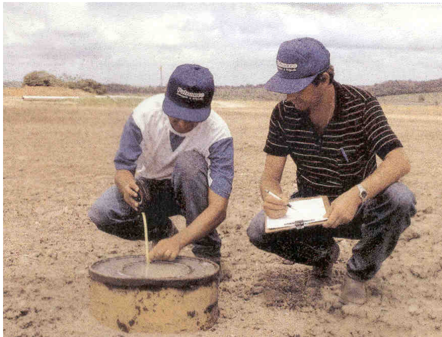
Figura 28 - Medida de infiltração com um infiltrômetro de anel.
