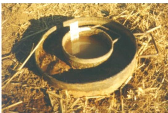
Figura III.6 – Infiltrômetro de anel em operação.
