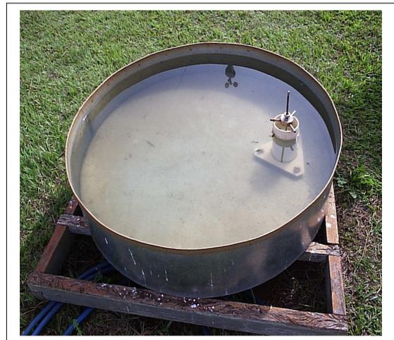
Figuras II.2-a e II.2-b – Tanque evaporimétrico “Classe A”.
