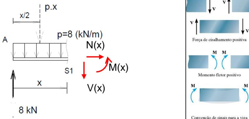
Ao aplicar o teorema do corte, a estrutura fica dividida sempre em duas partes.
