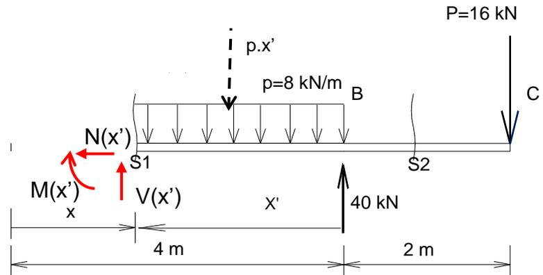
Lembrando da convenção de sinais para os esforços solicitantes no caso da viga horizontal (**força normal positiva é a de tração, força cortante positiva faz o corpo rígido girar no sentido horário, momento positivo traciona a fibra inferior do corpo rígido**), lançam-se esses esforços de acordo com a figura.
